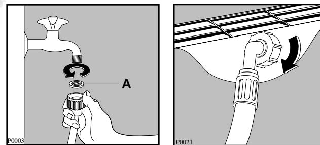
Другой конец наливного шланга, подключающийся к машине, может быть повернут в любом направлении. Ослабьте гайку, поверните шланг и вновь затяните гайку,
