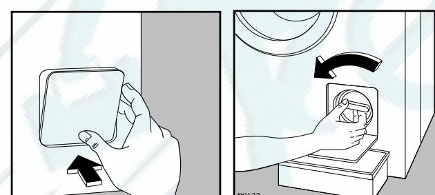
Промойте ее аккуратно проточной водой. Установите сетку на место и закройте крышку.
