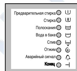
Лампа Аварийного сигнала мигает, если возникает неисправность стиральной машины. Одновременно с этим мигает одна из следующих ламп, а код ошибки на универсальном дисплее показывает тип ошибки.
